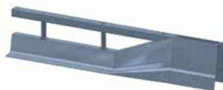
Übergang auf Betongleitwände
